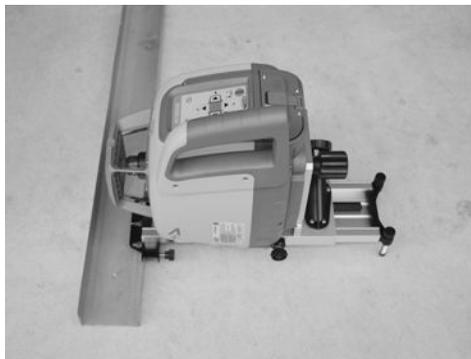
**Nota:** Si está utilizando el rayo perpendicular para la alineación, utilice el menú RC1402 para activar la función Beam Plunge para mover el rayo perpendicular a su marca de control de la pared más lejana.
